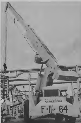
THIS WINCH truck can lift eleven tons. E WINCH truck aki por hiza dierun ton.
